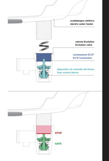
La nuova valvola – caratterizzata da un innovativo dispositivo di controllo del flusso – è inoltre dotata di una battuta meccanica (stop) che evita il rischio di danneggiamento e salvaguarda i componenti interni (safe).
