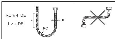
**IT** Non installare i tubi flessibili con raggi di curvatura inferiori a tre volte il diametro esterno del tubo. Non installare in tensione o in torsione.
