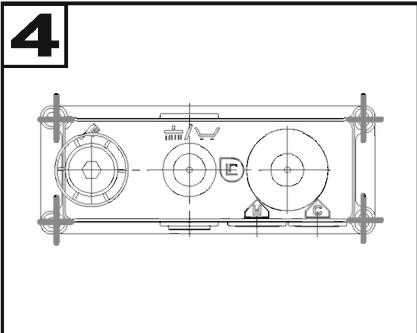
**IT** Predisposizione per fissaggio a strutture: cartongesso, legno, ecc.
