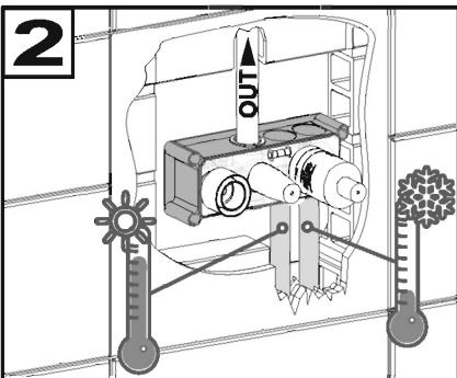
**IT** Attenzione! Assicurarsi di aver collegato entrambe le uscite ai condotti di erogazione prima di procedere. Non utilizzare tappi sulle uscite.
